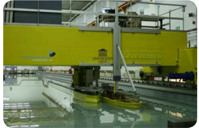
Schip-schip interactieproeven: Aframax en VLCC
