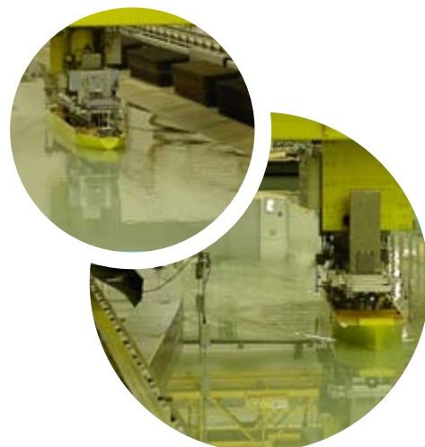
Het schip nadert dicht bij de speciaal ingebouwde oever. Zo kan men de krachten meten die inwerken op het schip.
