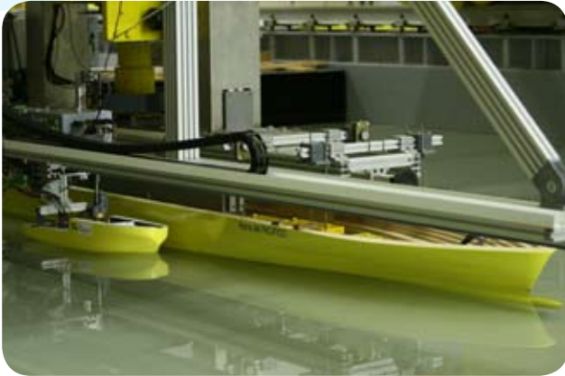
Scheepsinteractieproeven: sleepboot en containerschip
